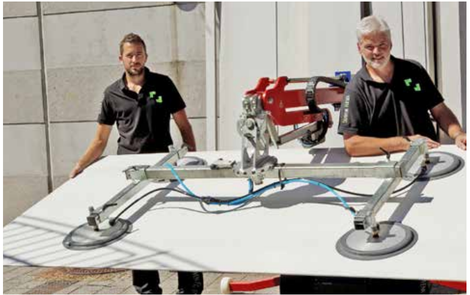
Die Großformatfliese ist fest mit vier Vakuumeinheiten fixiert und kann so mit dem Kran bewegt werden.
