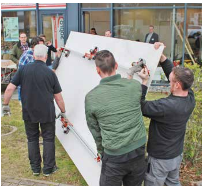
Das Tragegestell zum Transportieren der Fliese.
