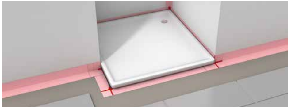
Die Duschwanne wird als großes Einbauteil betrachtet.
