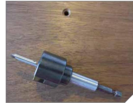
*Spezialbohrer mit eingebautem Versenker ermöglichen eine saubere und gleichmäßige Verschraubung.*
