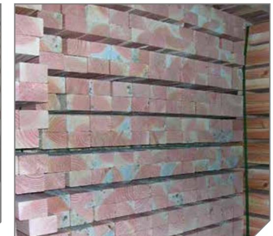
werden blaue bis grau-schwarze Verfärbungen hervorgerufen. Durch Holz Trocknung kann einer Verblauung vorgebeugt werden. Die Holzfeuchte sollte unter 20% liegen. Schimmelpilze können auch zu einer Verfärbung führen, sind aber nach Abtrocknung einfach durch Abfegen zu beseitigen. Diese Verfärbungen sind bei Terrassendielen kein Reklamationsgrund.
