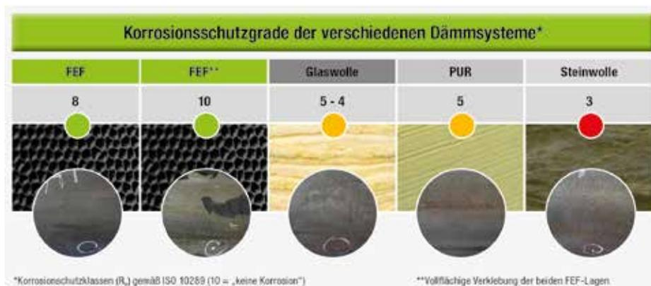
**Korrosionsschutzgrade der von InnCoa getesteten Dämmsysteme.**
