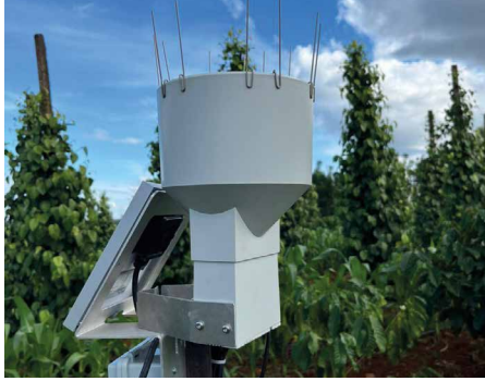
Der Rain Collector als intelligenter Sensor gibt Aufschluss über den tatsächlichen Niederschlag und verhindert so eine Über- oder Unterwässerung
